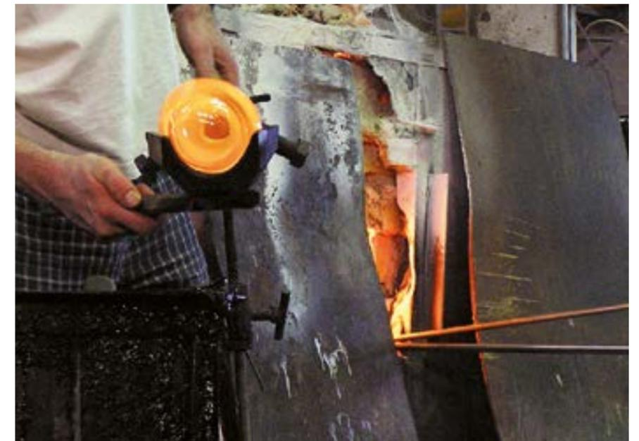
Die geblasenen Teile werden in Form gebracht
